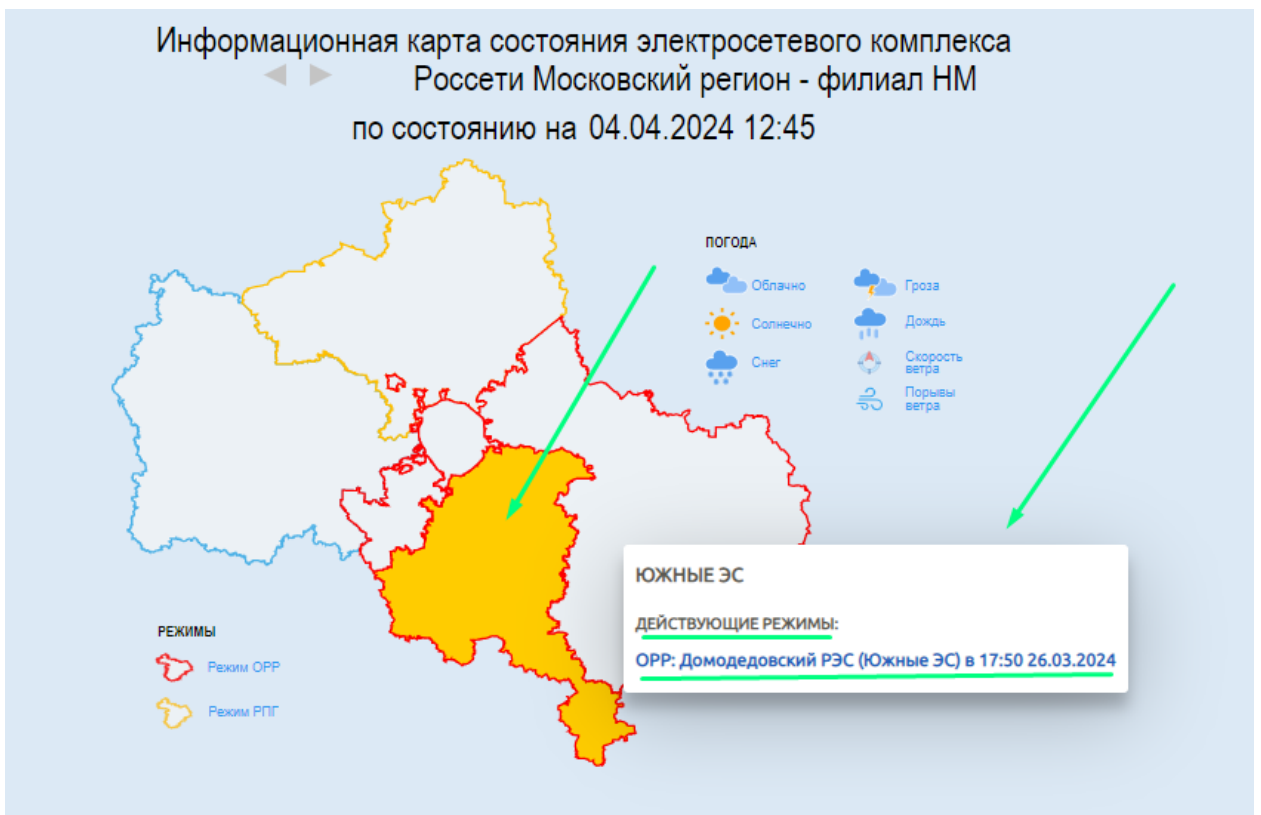
Рисунок 29 - КАД «Режимы». Действующий режим - ОРР
